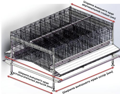
На схеме представлена конструкция с одной линией поения. Конструкция с двумя линиями поения предоставляется дополнительно
